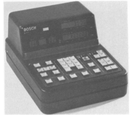
Figure G-1. Bosch-Fernseh BFS9 single frame display unit.
